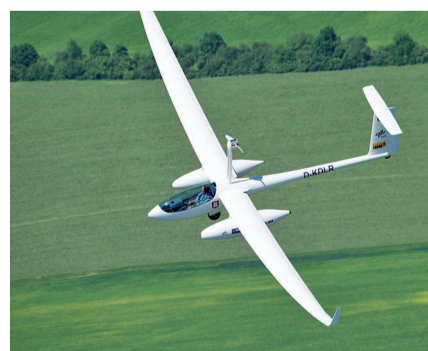
Die Antares DLR-H 2 der Lange Aviation war 2009 das erste bemannte, startfähige Flugzeug mit Brennstoffzellenantrieb. Foto: Deutsches Zentrum für Luft- und Raumfahrt e.V. (DLR)
