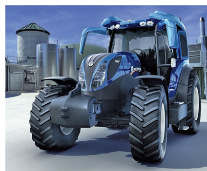
New Holland Agriculture stellte 2009 mit dem NH 2 den ersten Traktor mit Brennstoffzellenantrieb vor. Er hatte 120 PS und Energie für zwei Stunden Feldarbeit. Foto: New Holland
