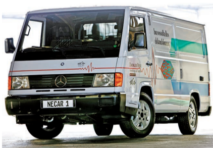
Das Mercedes-Benz NECAR 1 war 1994 das erste Brennstoffzellenfahrzeug der Welt. Der Antrieb nimmt den kompletten Laderaum des Transporters ein. Quelle: Daimler
