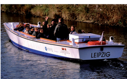
1999 war die Hydra der etaing GmbH das weltweit erste Passagierboot mit Brennstoffzellenantrieb. Sie fasste 22 Passagiere, der Wasserstoff im Bug reichte für 16 Stunden.
