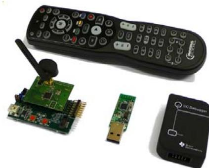
Evaluation-Kit zu einer ZigBee-basierten Fernbedienung (Quelle: Texas Instruments, [www.ti.com](http://www.ti.com))
