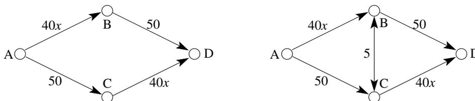
Abbildung 25.14: Braess-Paradox: Kapazitätserhöhung führt zu schlechterer Netzauslastung
