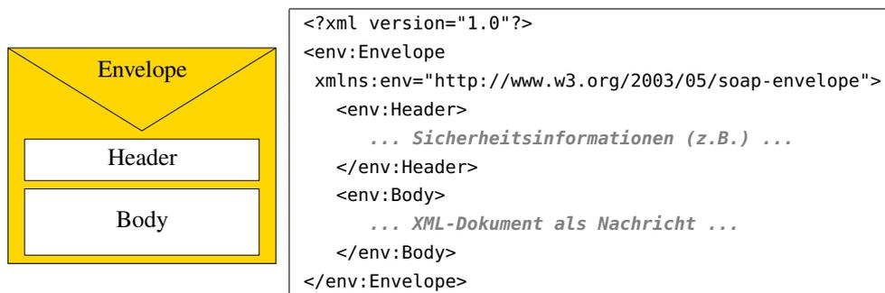
Abbildung 20.3: Aufbau einer SOAP-Nachricht, nach Melzer (2008:§5.4)
