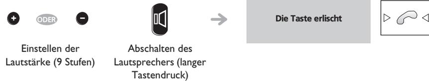
Ein kurzer Druck auf die Lautsprechertaste ermöglicht den Übergang in die Betriebsart „Freisprechen“ (Anzeige leuchtet ständig).
