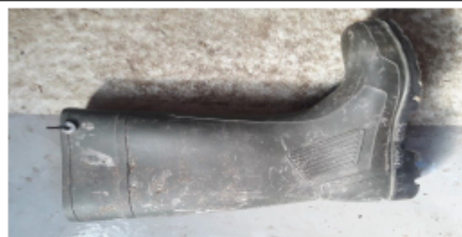
Abbildung 2: Stiefel mit am Schaft befestigtem Magnetkontakt
