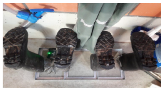
Abbildung 3: Fertiger Versuchsaufbau mit Stiefeln auf dem Halter mit Kontakt zur Sendereinheit (Status: fängisch)
