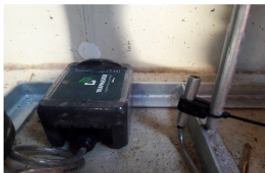
Abbildung 1: Trapmaster ® Fallenmelder-Sendereinheit und Magnetkontakt am Stiefelhalter befestigt
